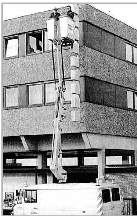
Heute hat der Birnengreifer ausgedient – Hubsteigerfahrzeug im Einsatz
